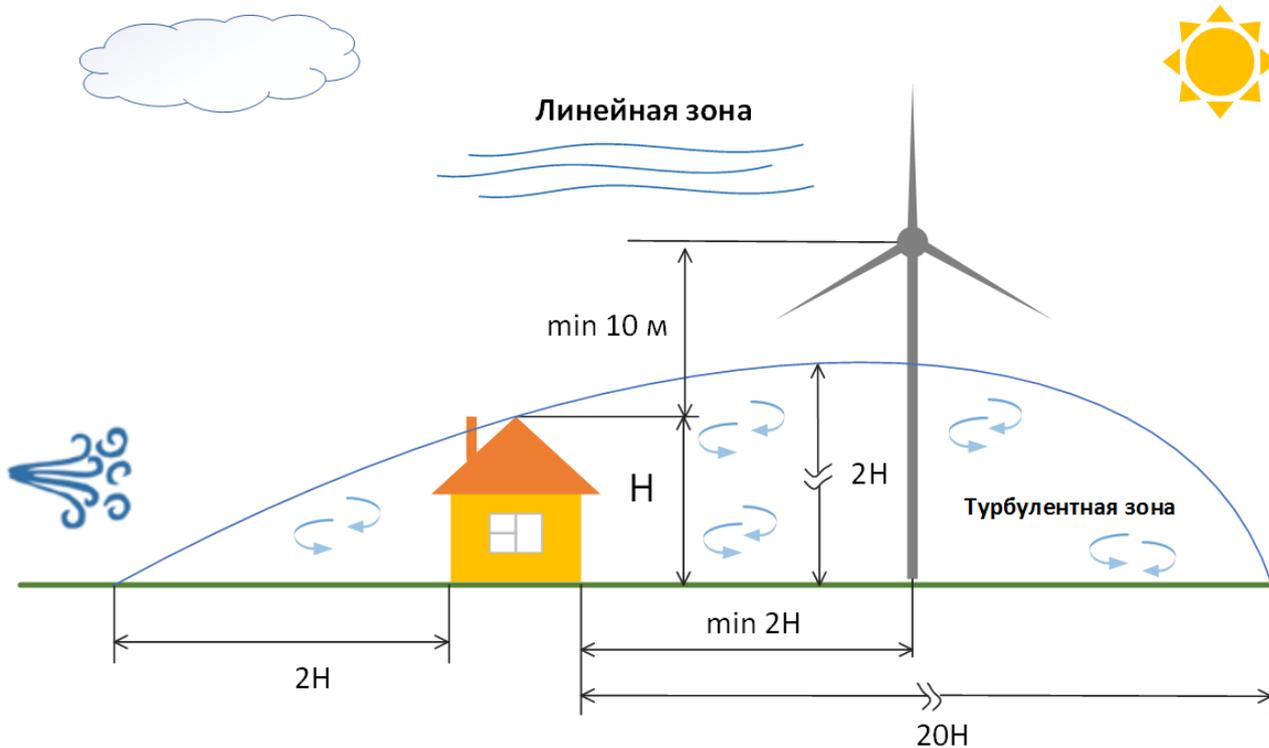
Рисунок 3 – Расположение ветрогенератора по отношению к препятствиям.
