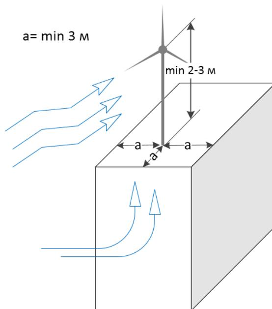
Рисунок 4 – Расположение ветрогенератора на крыше здания.
