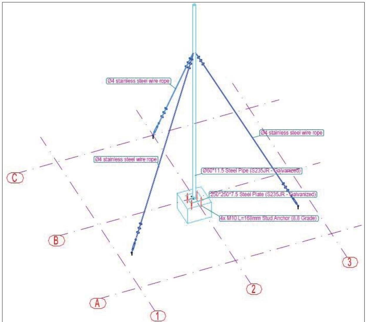
Рисунок 7 – Схема основания для установки мачты.
