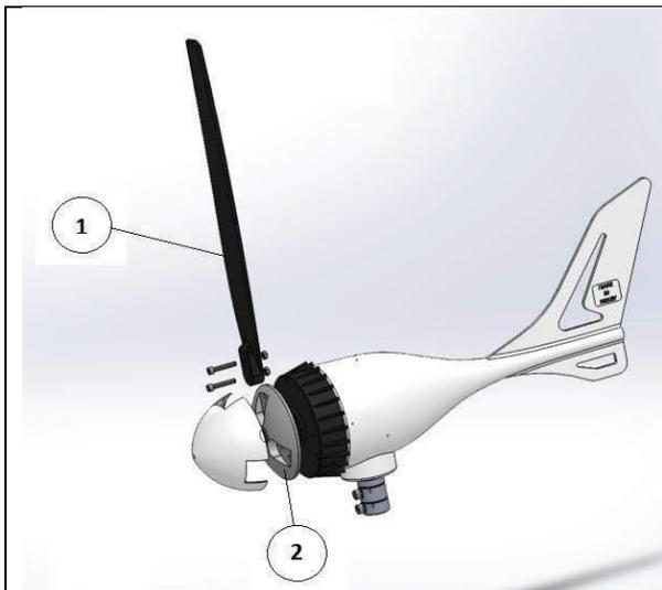
Рисунок 5 – Сборка ветрогенератора.
